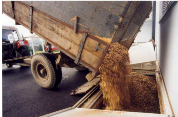
Llenado del depósito mediante camión con volquete
