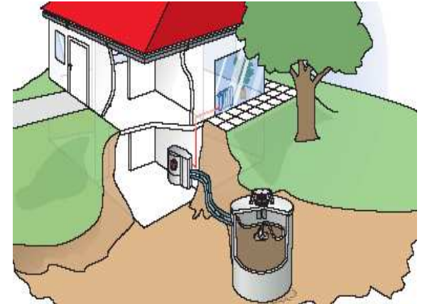
Depósito de pélets enterrado en el exterior del edificio
